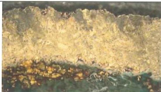
**Fig. 8. Fotografía de microscopía óptica de la sección transversal de la lámina que conforma la esfera YA3 atacada con FeCl<sub>3</sub> en etanol (X10).**
