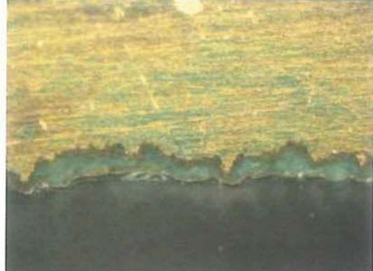
**Fig. 5. Fotografía de microscopía óptica de la sección transversal de la lámina que conforma la esfera YA3. Detalle de la pátina exterior (X20).**
