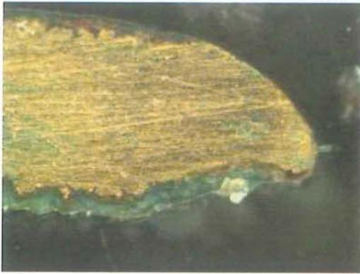
**Fig. 4. Fotografía de microscopía óptica de la sección transversal de la lámina que conforma la esfera YA3 (X20).**
